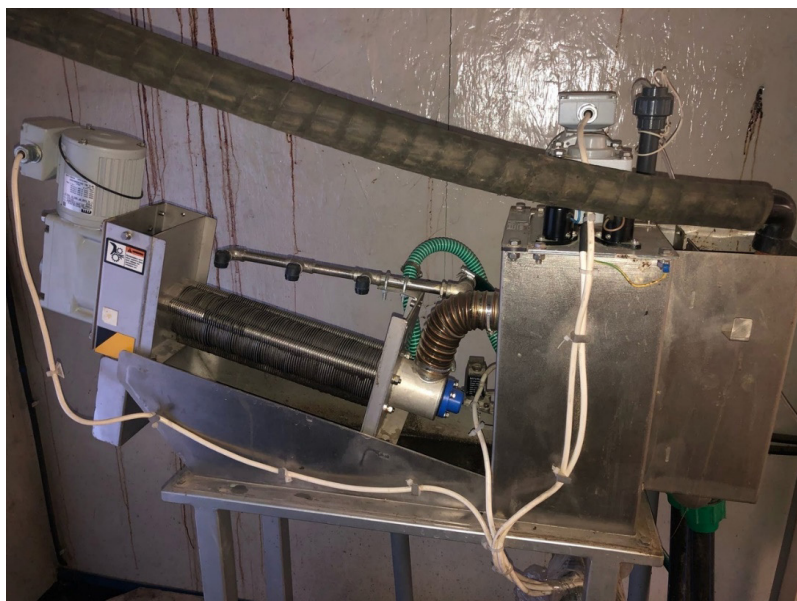
Внешний вид шнекового дегидратора во время проведения эксперимента
