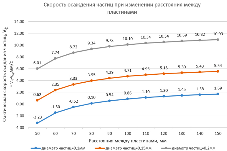
Рис. 3. График зависимости скорости осаждения от расстояния между пластинами модуля
